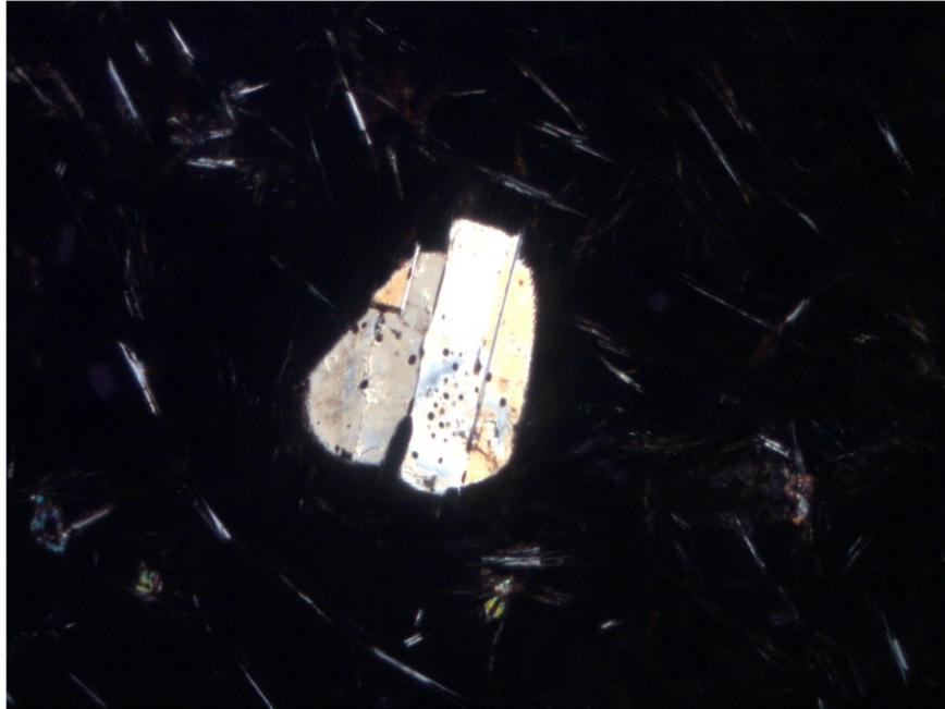
Figura 64- Fotomicrografia em luz polarizada, amostra EN61 25, matriz vítrea muito escura e fenocristais de plagioclásio com microinclusões sólidas e fluídas, NC, 25X
