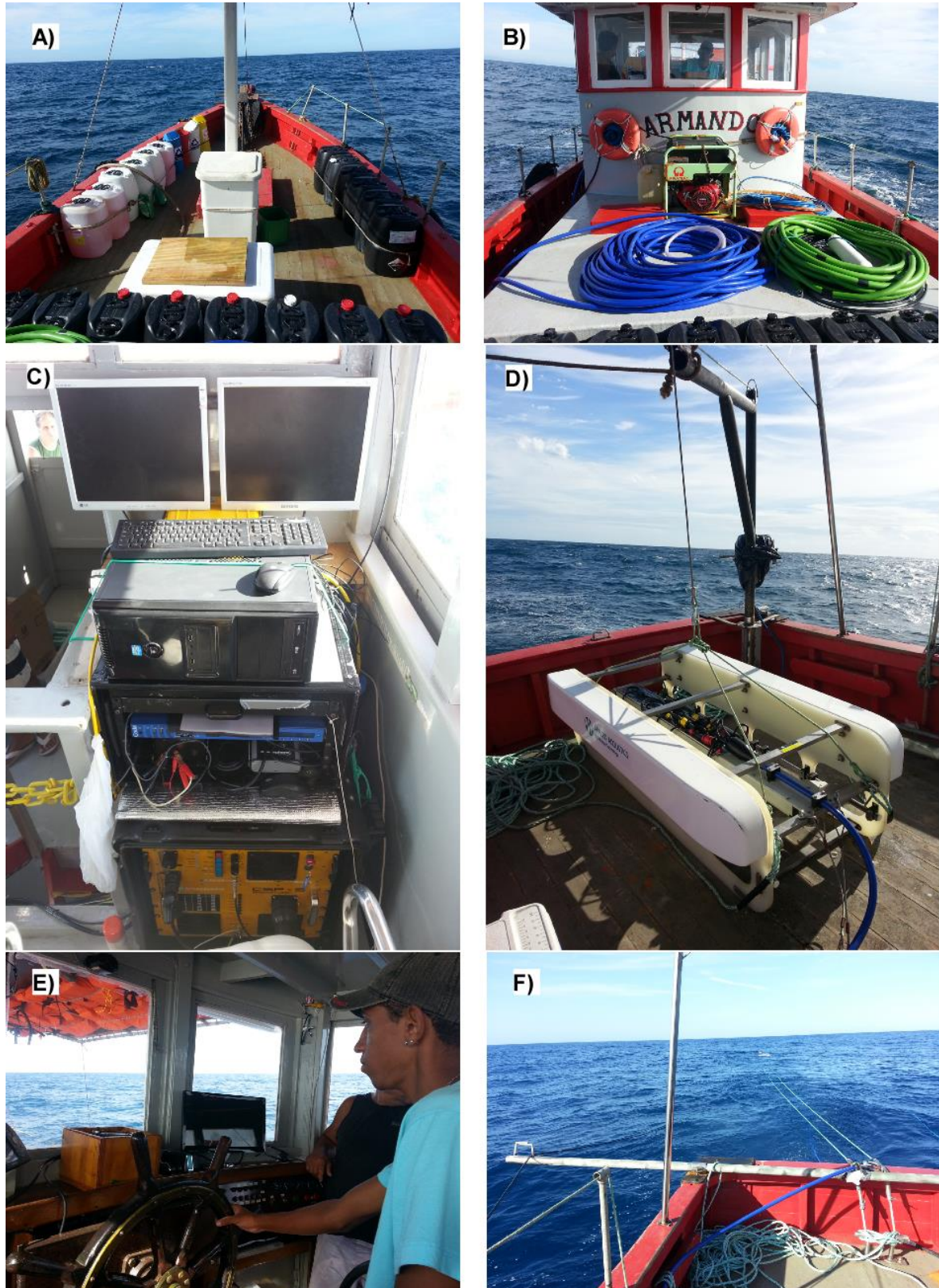
Figura 21: Fotos da embarcação Armando adaptada para levantamento sísmicos (A e B), enguias de hidrofone monocal e multicanal (verde) (B), catamarã com fonte sísmica (C), banco de capacitores e sistema de aquisição (D), navegação de posicionamento (E), reboque da fonte e enguia durante operação (F). Fotos: Marcela Coronel, 2014.
