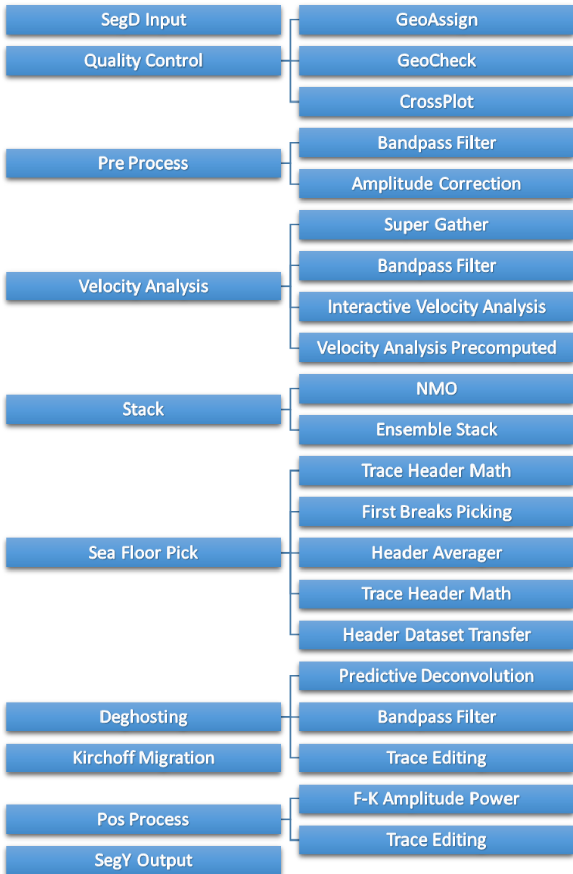
Figura 22 Fluxograma do processamento de dados sísmicos multicanal de alta resolução da campanha de aquisição Rio Mar 4 no software RadExPro.
