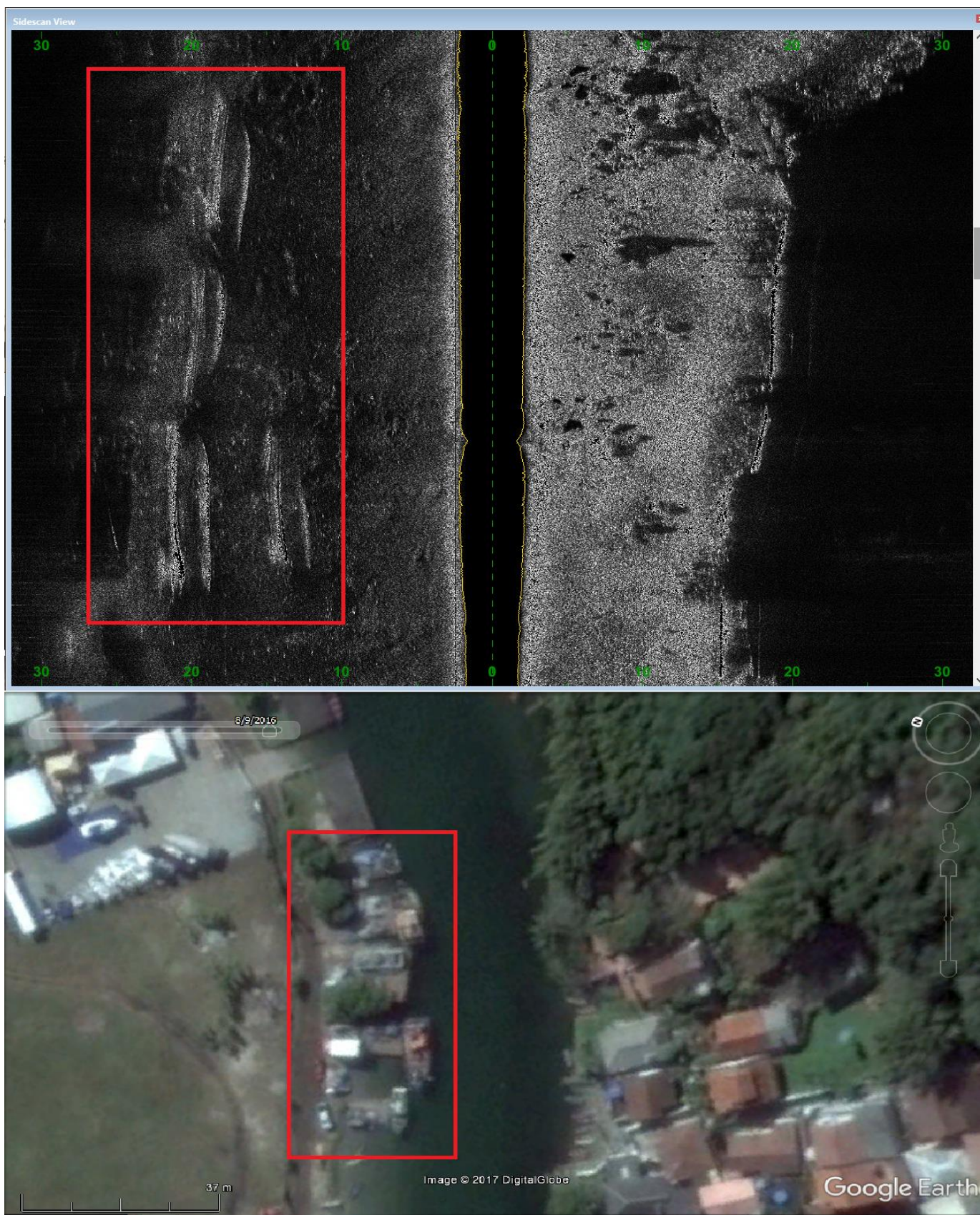
Figura 45 – Imagem de SVL destacando o registro das quilhas das embarcações que se encontram atracadas nos trapiches ao longo do Canal da Barra da Lagoa (quadro vermelho). Imagem de satélite retirada do software Google Earth Pro. Escala de distância de 37m.
