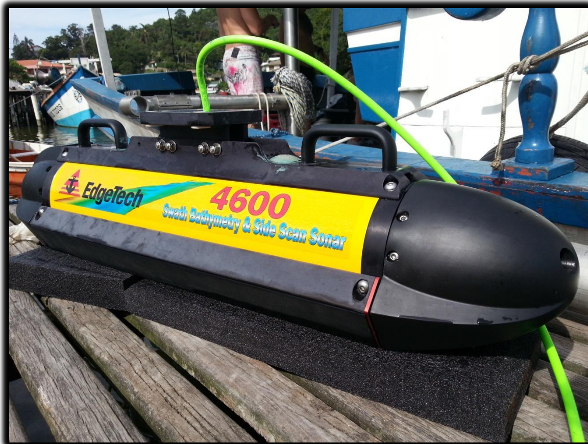
Figura 4 – Fotografia demonstrando o Sonar Diferenciador de Fase Edgetech 4600 e seu arranjo de transdutores laterais.
