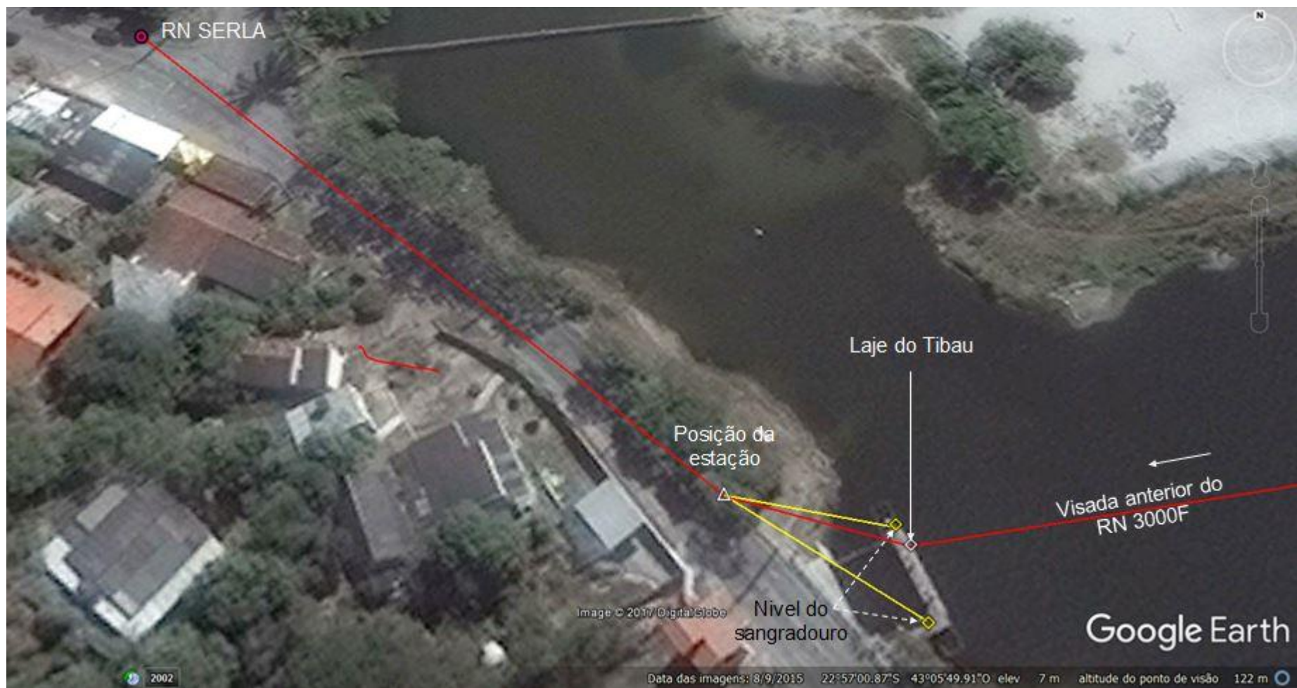
Figura 62 Mudança da estação para o Tibau Verificação do RN da SERLA, da laje do Tibau e do nível superior do sangradouro.
