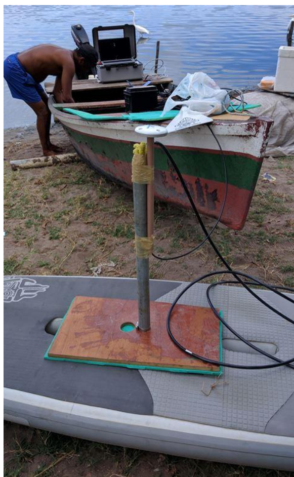
Figura 33 No primeiro plano transdutor e DGPS, ao fundo “Vandeco” e o EA-400.
