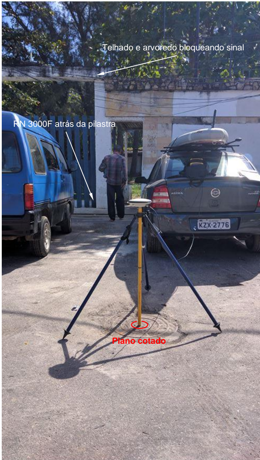
Figura 50 Aquisição de posição e altura elipsoidal próximo ao RN 3000F.
