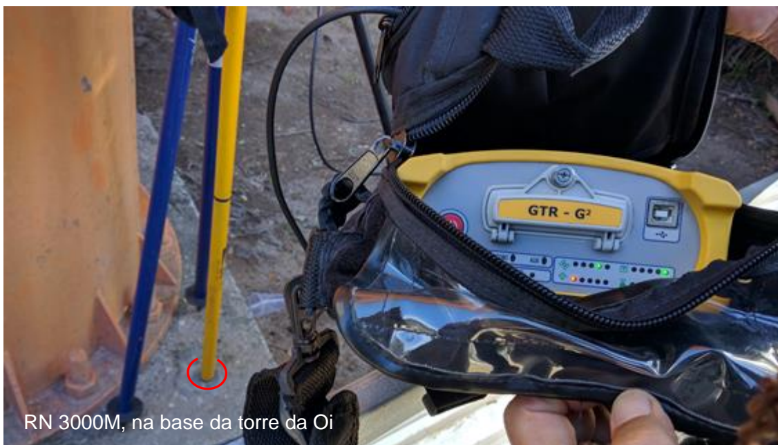
Figura 51 Ocupação do RN 3000M, junto à base da torre de telefonia da Oi.
