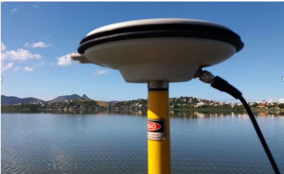
Figura 56 A antena do DGPS fixada exatamente sobre a posição anterior do ponto T2.
