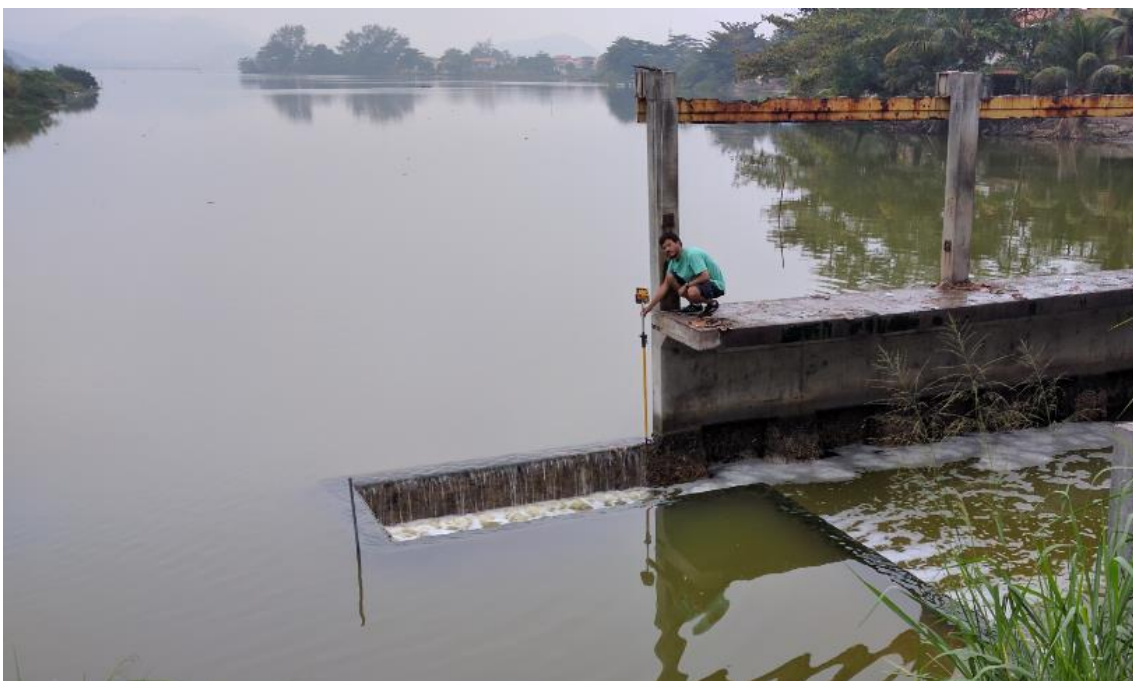
Figura 61 Determinação da altitude ortométrica do nível da lagoa.
