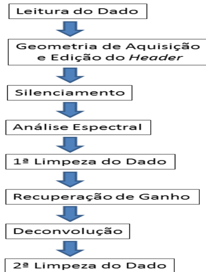
Figura 32 - Fluxo de processamento de dados sísmicos rasos ( Kestemberg et al. , 2012)
