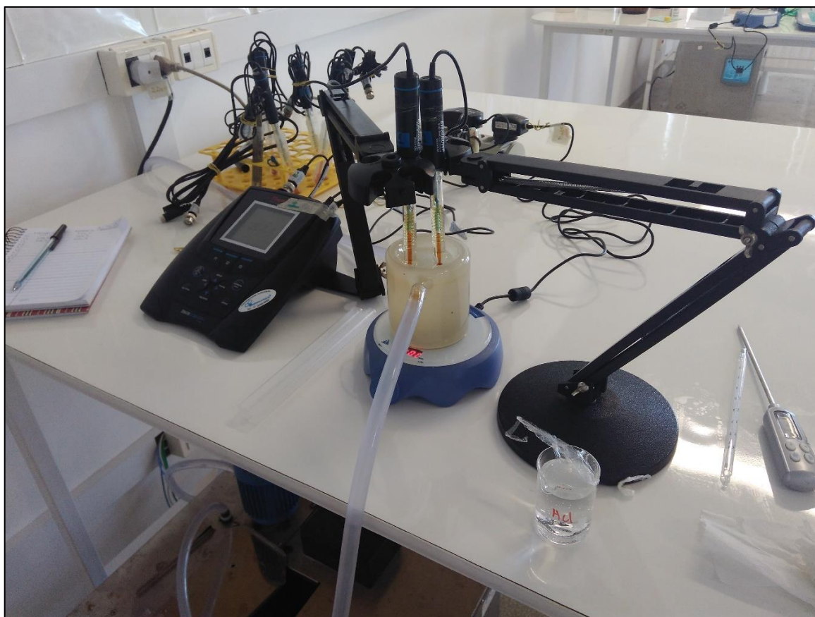
FOTO 6 Avaliação do desempenho dos eletrodos utilizando célula termoestativada acoplada a banho termoestativado e potenciômetro
