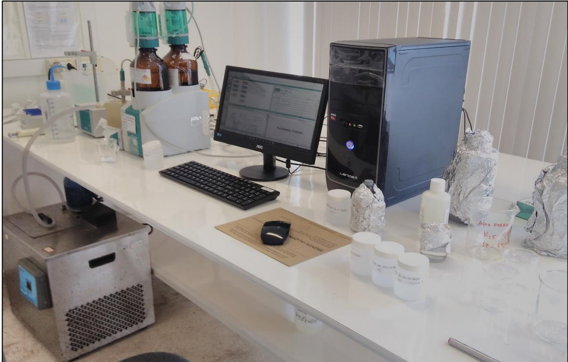
FOTO 1: Conjunto Titulador automático Titrand – Metrohm, software Tiamo 2.0, condutivímetro 856 e banho termostatizado microprocessado.
