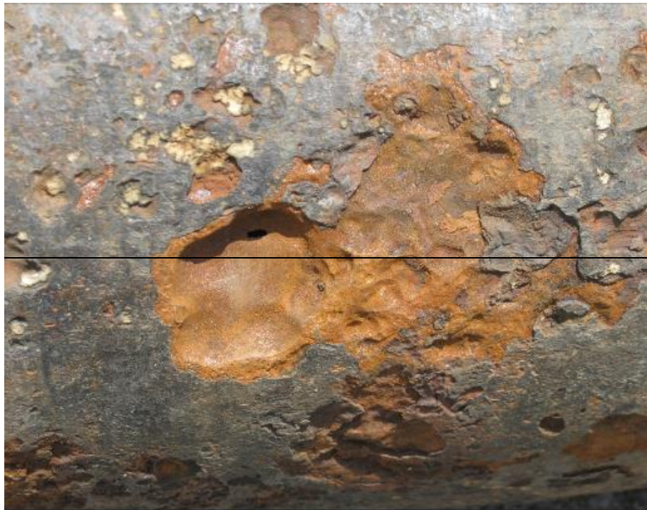
Figura 10: Exemplo do efeito do CO2 em revestimentos produtores de óleo e gás (Oliveira, 2015).
