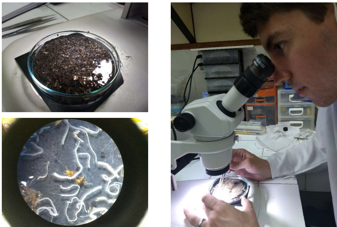
Figura 6: Etapa da triagem dos organismos bentônicos com auxílio de lupa e pinça em laboratório.
