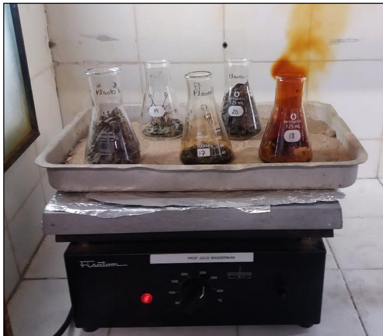
Figura 67 – Queima da matéria orgânica das folhas com ácidos. Foto: Dias, 2017.
