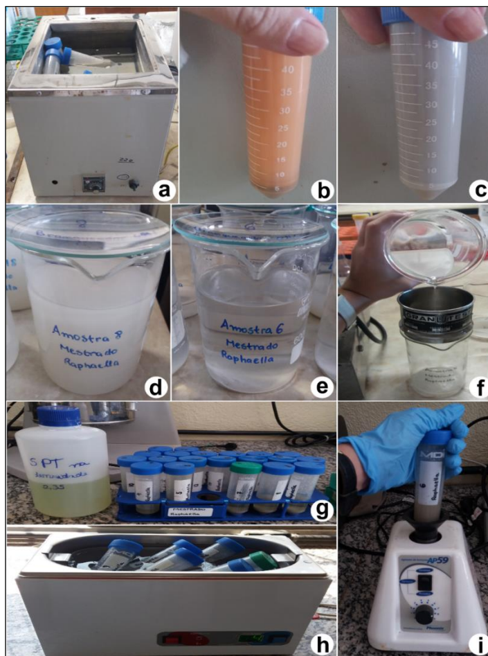
Figura 64 – Etapas de solubilização de ferro, remoção de argila, peneiramento, secagem e separação densimétrica. Legenda: a, b, c – solubilização do ferro; d, e – remoção de argilas; f – peneiramento; g, h, i – separação densimétrica. Fotos: Dias, 2017.
