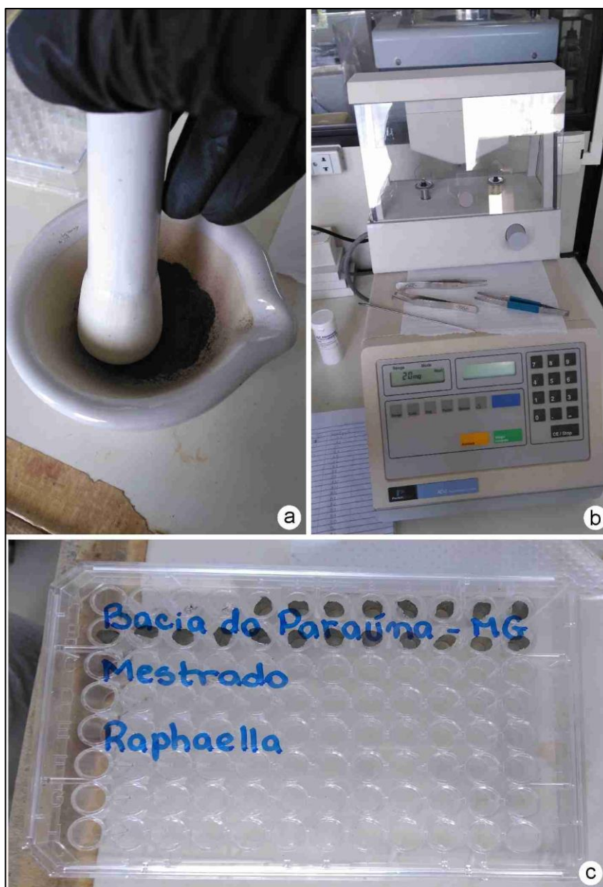
Figura 61 – Amostra sendo macerada (a), pesada na balança de alta precisão (b), guardada em bolinhas de alumínio completamente fechadas (c) e novamente pesada para conferir se não houve perda de amostra. Fotos: Dias, 2019.
