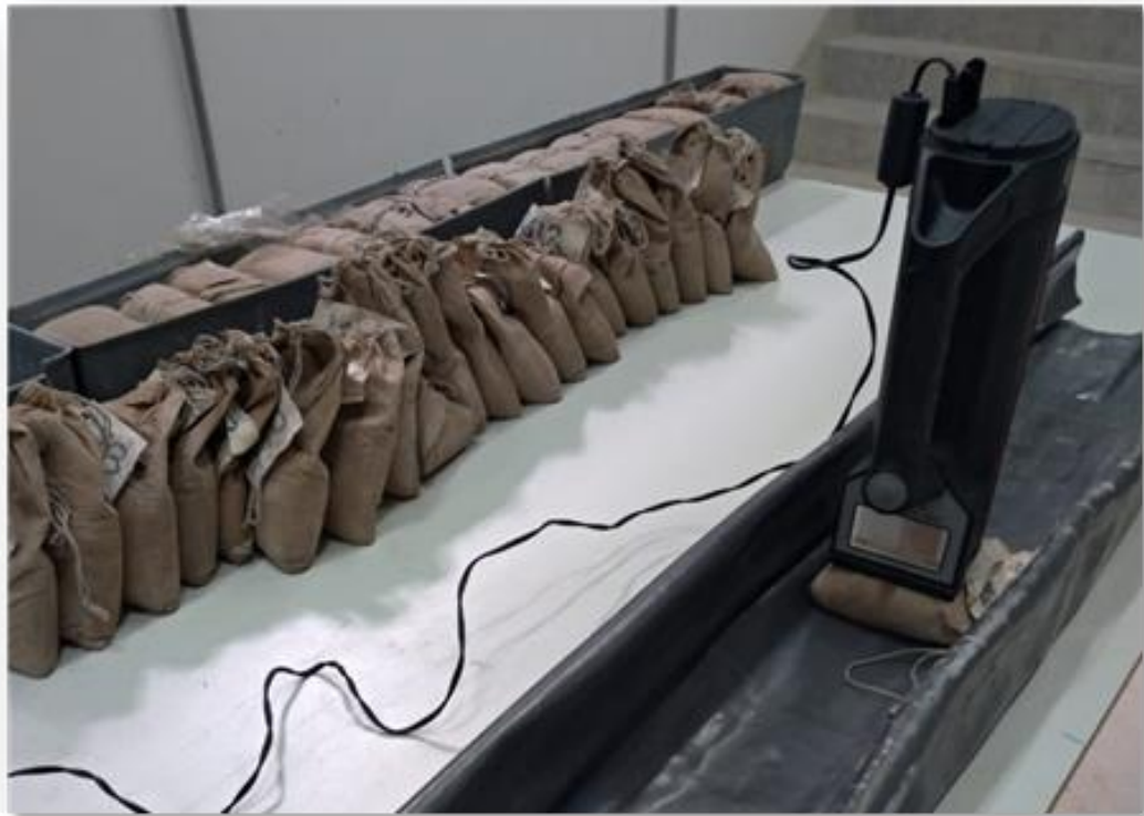
Figura 30: Foto do gamaespectrômetro utilizado nas amostras de calha para a geração das curvas individualizadas de tório, urânio e potássio. Fonte: Nobre (2019).
