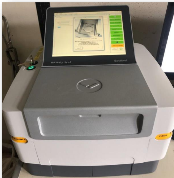
Figura 29: Foto do equipamento Espectrômetro de Fluorescência de Raios-X utilizado para a geração das curvas de elementos químicos presentes nas amostras de calhas. Fonte: Workshop do Projeto Parnaíba (outubro/2019).
