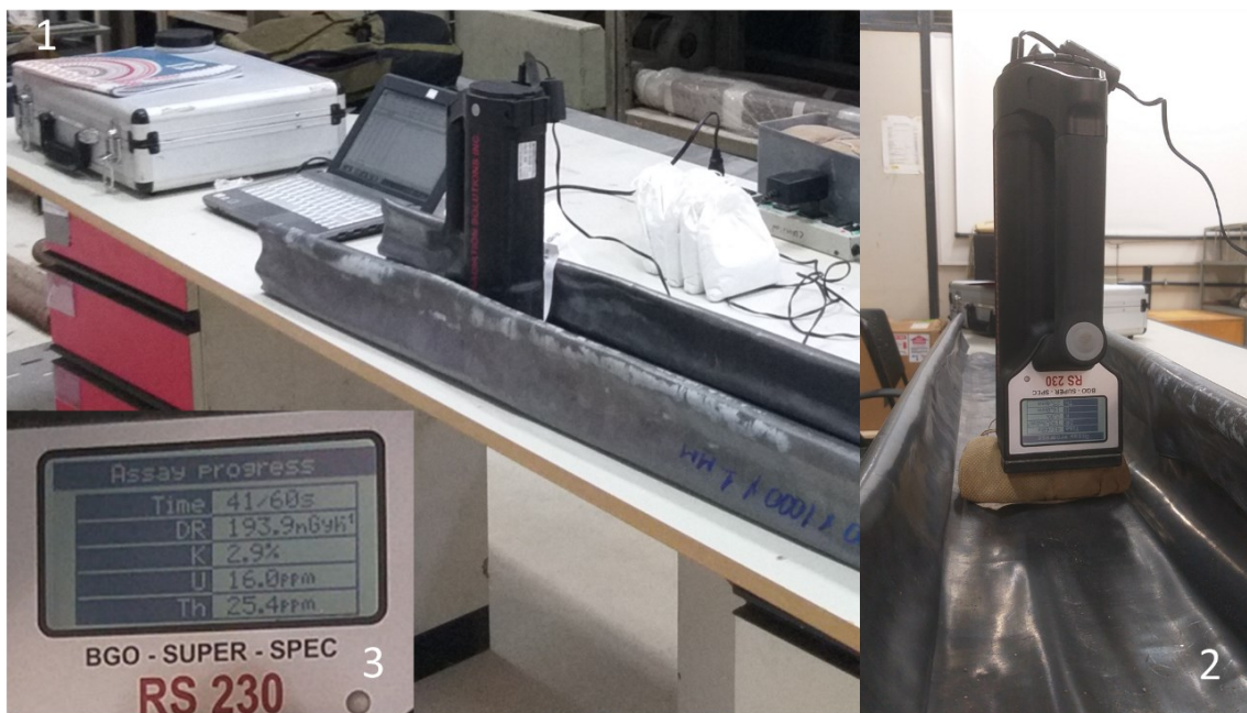
Figura 20 1 e 2) Aquisição de dados de raios gama total e espectral, a partir de amostra de calha, em saco de tecido tnt , com o gamaespectrômetro portátil RS-230, sobre a malha de chumbo, no laboratório da UFF. 3) Detalhe da tela do equipamento.
