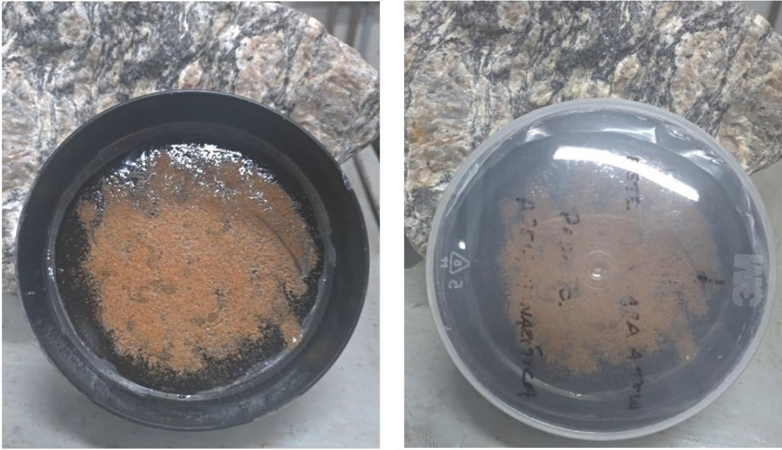
Figura 22 Amostra padrão, cilindro plástico com 8,5 cm de diâmetro, contendo areia monazítica coberta por resina (Nobre, 2019).
