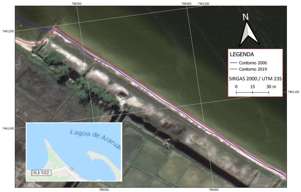
Figura 12 – Depósito de sedimentos logo após área de erosão, região 15.
