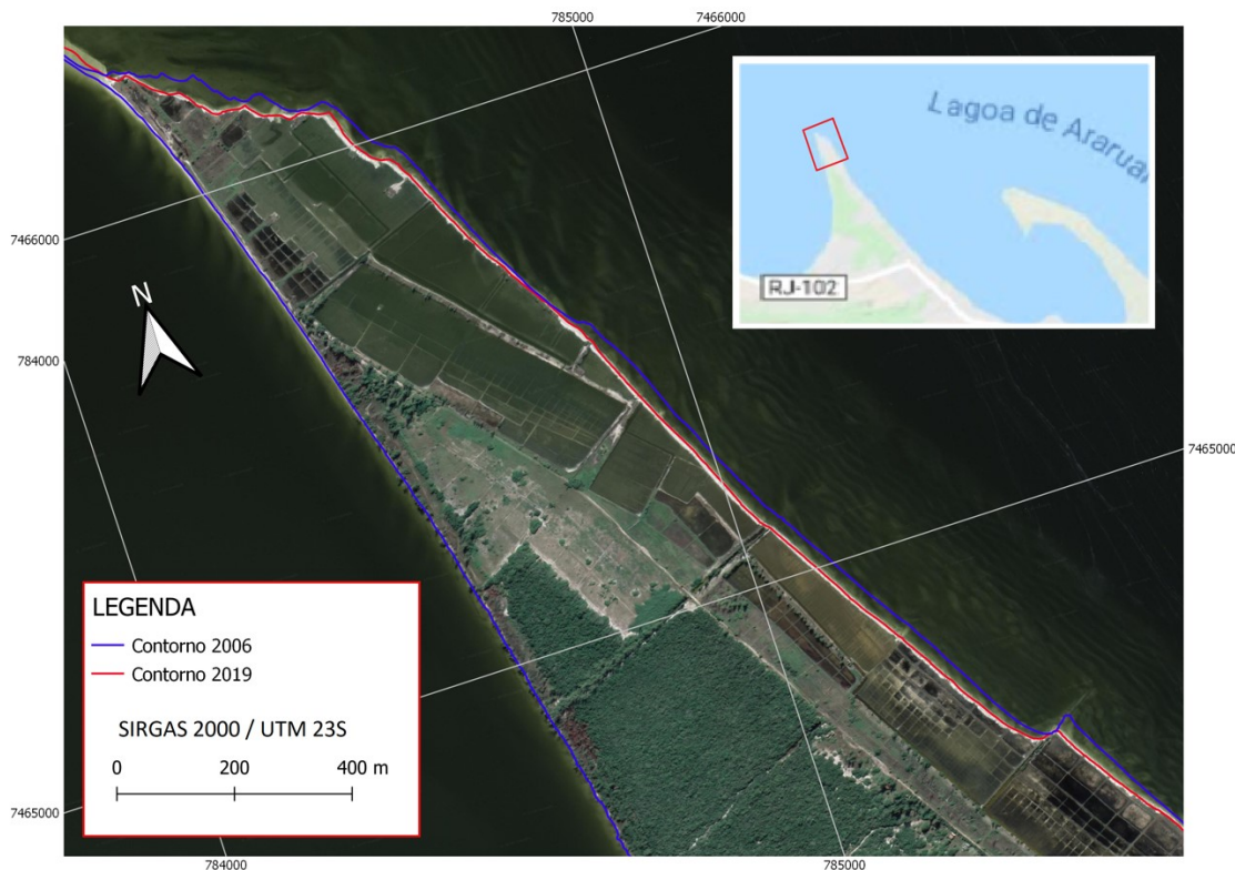
Figura 9 – Erosão próxima a ponta do esporão, região 7.
