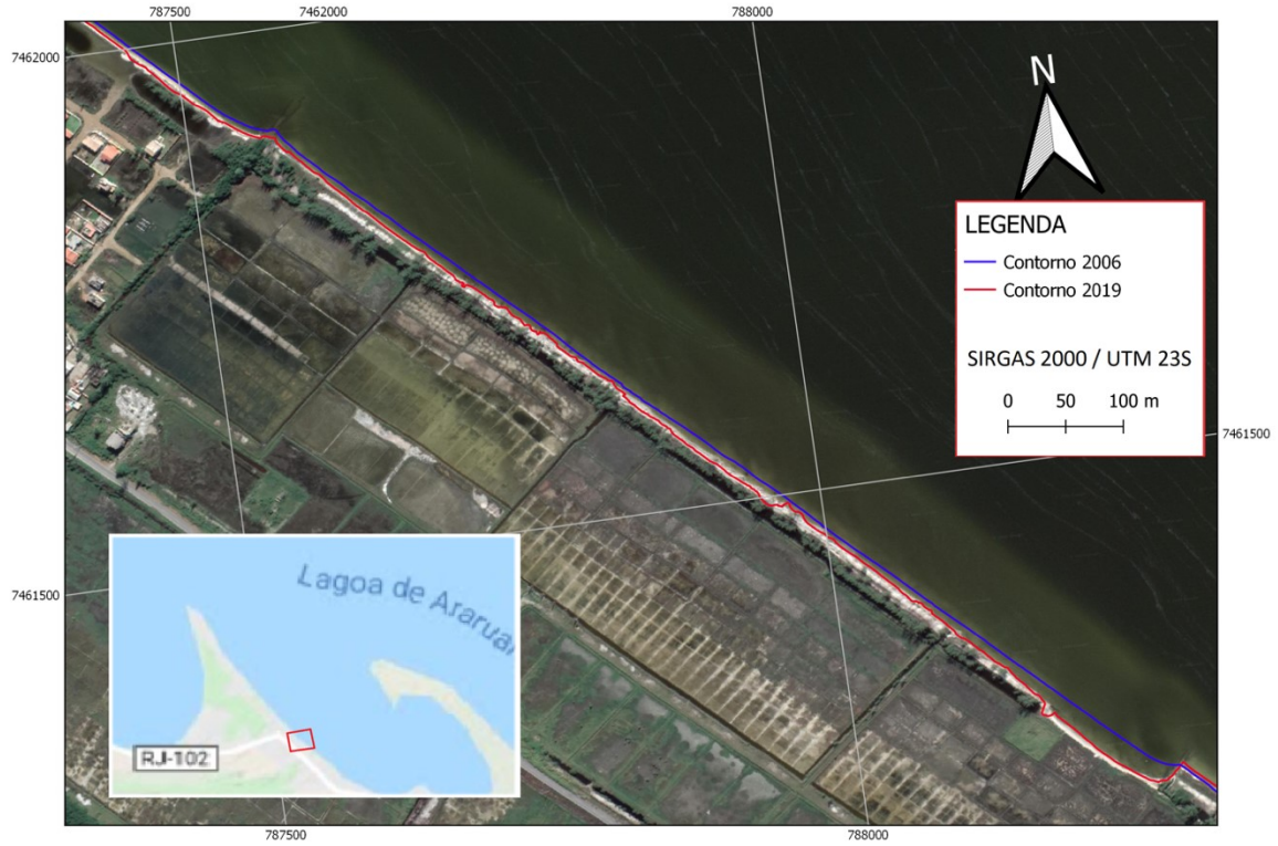
Figura 11 – Erosões identificadas, regiões 13 e 14.
