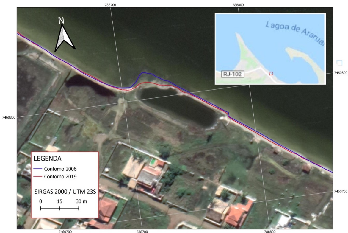
Figura 13 – Identificação de erosão, região 15.
