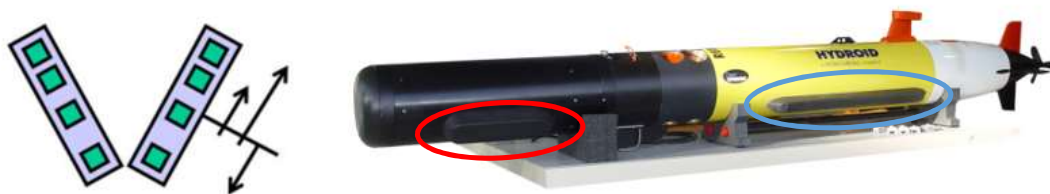
Figura 22 – Na esquerda, a disposição dos elementos em uma visão frontal. Nele pode-se ver o transmissor e os diversos pares de receptor espaçados em diferentes distâncias. Fonte: CLARKE (2013a). Na direita tem-se o equipamento montado em um AUV REMUS 100S da Empresa Kongsberg Maritime. Nele, o transdutor mais de ré é de um sidescan sem interferometria (dentro do círculo azul). O que está à frente (dentro de um círculo vermelho) é o Geoswath Plus, um sidescan sonar interferométrico. O array é disposto no sentido do deslocamento do equipamento. Fonte: adaptado de KONGSBERG MARITIME (2015).
