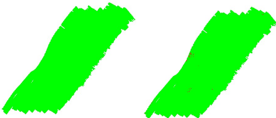
Figura 75 – Camadas de superfícies da área 2 criadas a partir das equações 3 e 5. A da esquerda é representativa da incerteza da hipótese. A da direita é representativa da incerteza amostral do nó. Ambas são relativas ao ecobatímetro multifeixe. Em verde estão todos os nós cujos valores foram negativos, ou seja, alcançaram a Ordem Especial, enquanto que em vermelho estão representados os valores positivos.
