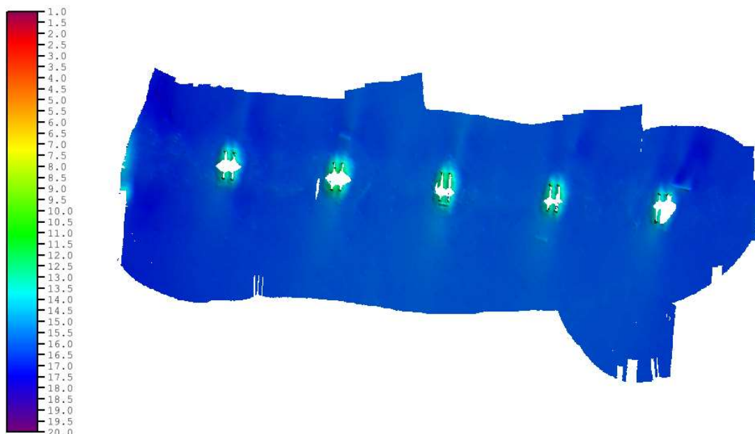
Figura 87 – Superfície CUBE MBES na resolução de 0,5 m contendo as informações de profundidade (camada Depth) oriundas do levantamento com o MBES. Escala em metros.
