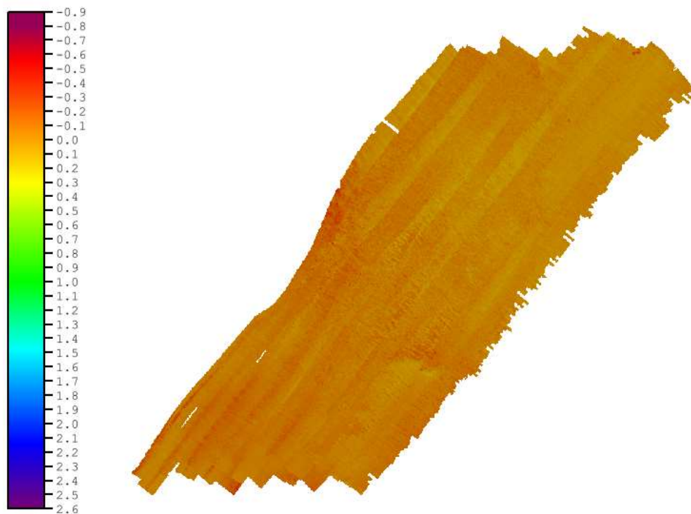
Figura 78 – Superfície diferença para a área 2. A diferença é entre as camadas Depth do MBES e do PDBS.
