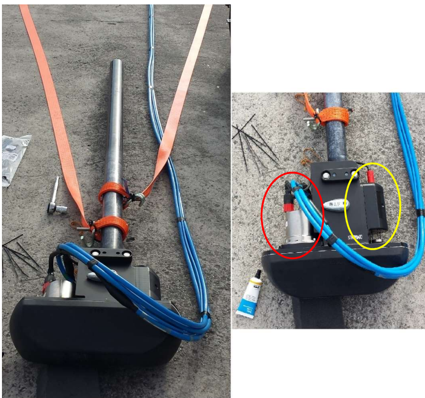
Figura 40 – Sonar de varredura lateral Geoacustics Geoswath 4R instalado em haste. À direita, no círculo vermelho tem-se o sensor de movimento e no amarelo o sensor de velocidade do som na face do transdutor.
