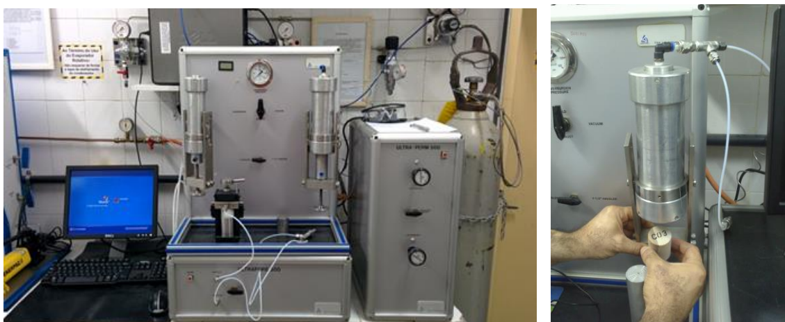
Figura 5.2: Esquerda: foto do porosímetro ULTRAPORE 300 e do permeametro ULTRAPERM 500 no laboratório de petrofísica do UFFLAR. Direita: célula Hassler em destaque, acoplada aos dois aparatos.
