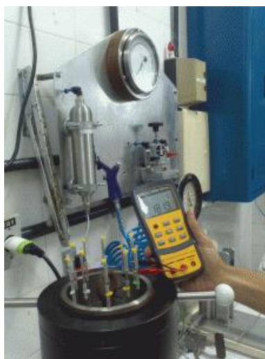
Figura 5.3: Foto da célula Multicore (Phoenix Instruments) sendo usada parâmetros elétricos no UFFLAR.
