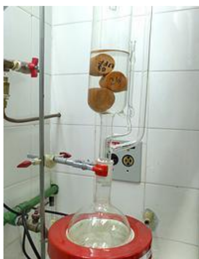
Figura 5.1: Foto de um Extrator Soxhlet operando no laboratório de petrofísica do UFFLAR.
