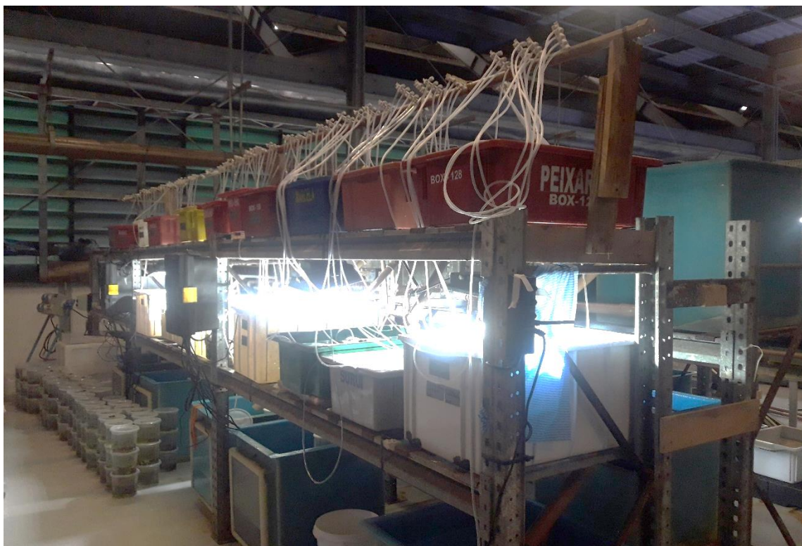
Figura 7. Disposição dos tanques para o estudo piloto 2. Os ouriços-do-mar foram alocados no nível superior, as algas no nível intermediário e o sistema de circulação com skimmer nos tanques inferiores. Foto da autora.
