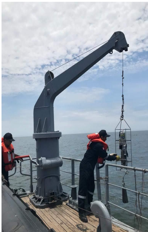
Figura 11 - Lançamentos CTD para amostragem de condições oceanográficas. a) Lançamento do CTD durante um cruzeiro oceanográfico a bordo do B.A.P. “Carrillo” (AH-175). b) Lançamento da roseta oceanográfica com CTD a bordo do B.A.P. “Carrasco” (BOP-171). (Galeria de fotos DIHIDRONAV).
