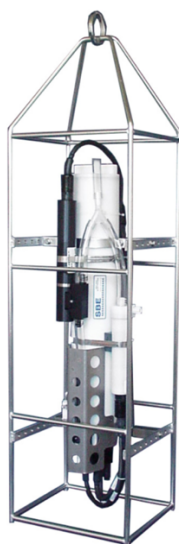
Figura 13 - Imagem do SBE 9plus CTD. Fonte: SEA-BIRD ELECTRONICS (2016).
