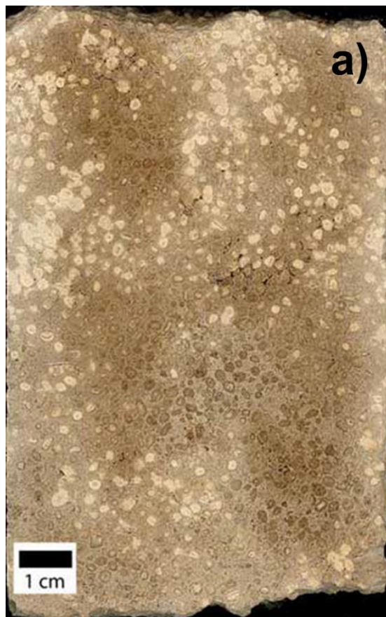
Figura 9: Imagens de testemunho das fácies C e D (Associação de Fácies 2): a) grainstone oncolítico peloidal da fácies C; e b) packstone oncolítico bioclástico da fácies D. Fonte: Okubo (2014).
