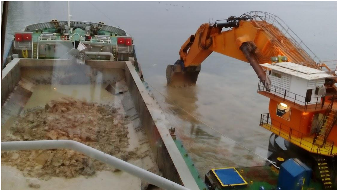
Figura 2: Draga Sinsom e embarcação Petter Caland, usados na dragagem do porto do Rio de Janeiro. Foto por Luiz Henrique Fontana
