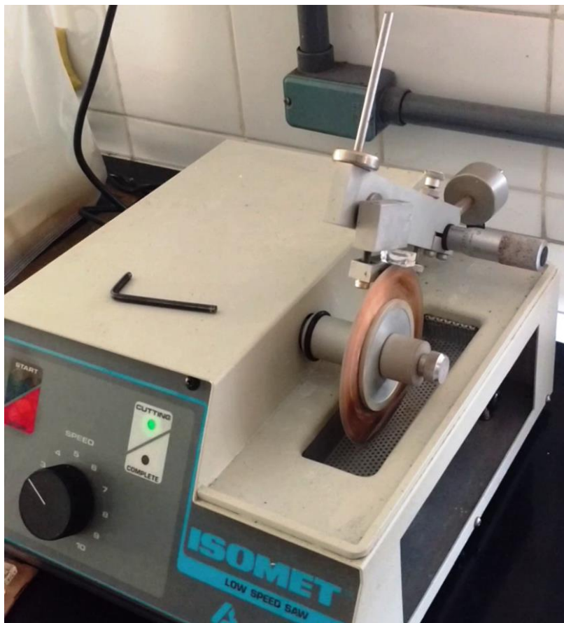
Figura 6. Serra metalográfica de baixa rotação (Buehler-Isomet) equipada com lâmina adiamantada.
