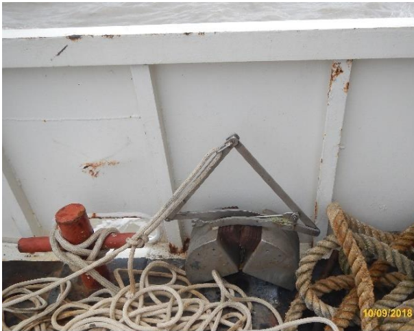
Figura 21: Detalhe da draga do tipo Van Veen utilizada para coleta de sedimentos. Fonte própria
