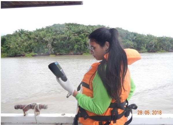
Figura 14: Análise dos Parâmetros físico-químicos realizados através da sonda multiparâmetros.
