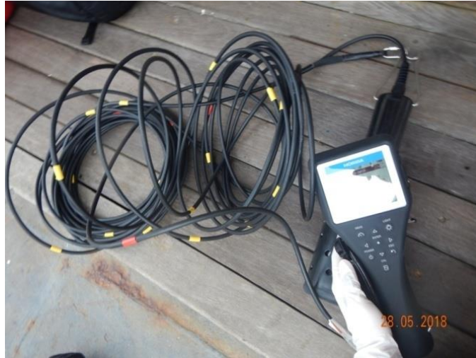
Figura 20: Detalhe da sonda multiparâmetros Horiba U51 para análise dos parâmetros físicos- químicos
