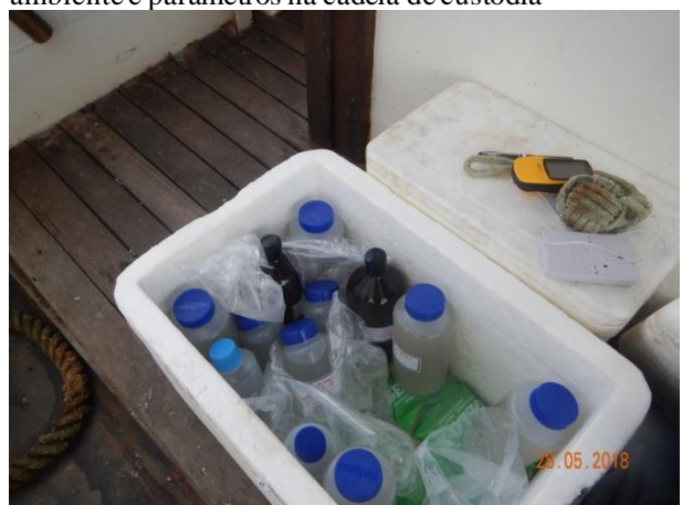
Figura 17: Detalhe das amostras condicionadas em gelo para conservação das propriedades até a análise em laboratório
