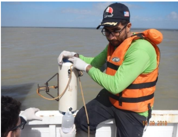
Figura 18: Detalhe da garrafa Van Dorn utilizada para coleta de amostras d'água em diferentes profundidades. Foto de autoria própria
