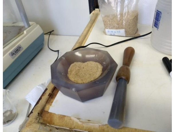
Figura 26: Amostra de sedimento (0,500g) sendo macerada com almofariz e pistilo após o processo de liofilização.
