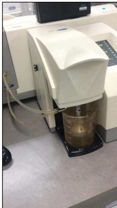
Figura 17. Análise de uma fração do testemunho no equipamento Mastersizer 2000.
