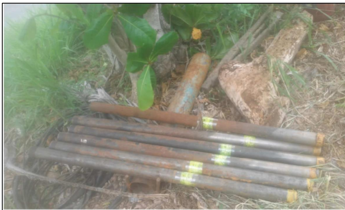
Figura 12 - Tubos utilizados para retirada dos sedimentos. Foto: Sondeq (2017).
