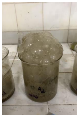
Figura 15 – Amostra de sedimentos sendo atacada por H_2O_2 para a determinação de matéria orgânica – Laboratório de Sedimentologia da UFF.
