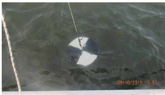
Figura 14 – Análise da transparência da água por meio do Disco de Secchi.
