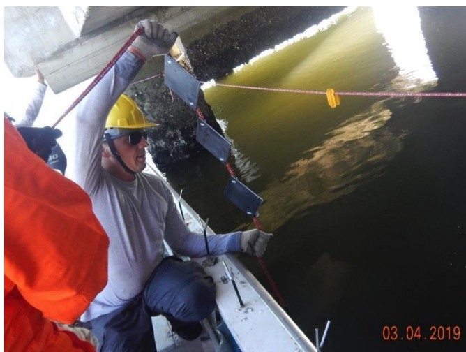
Figura 4 As três placas de assentamento já fixadas no cabo para uma das três profundidades amostradas no canal do Porto de Santos, SP.
