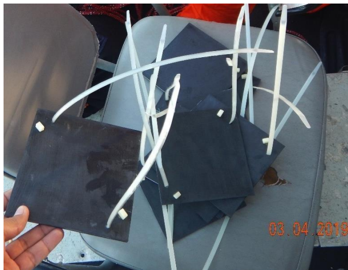
Figura 2 Placas de assentamento de policloreto de vinila (PVC), com as presilhas de fixação no cabo de placas, para análise de espécies exóticas invasoras no canal do Porto de Santos, SP.
