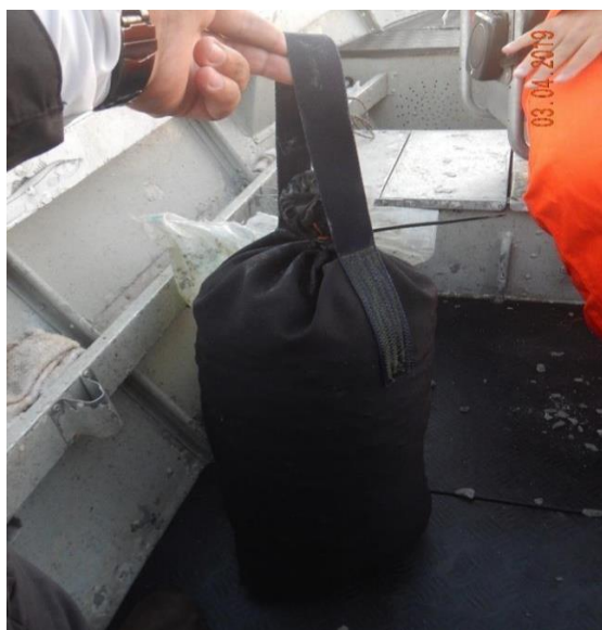
Figura 3 Saco de lona de nylon de alta resistência preenchido com 20 kg de brita média, utilizado como contrapeso nos cabos de placas, para análise de espécies exóticas invasoras no canal do Porto de Santos, SP.
