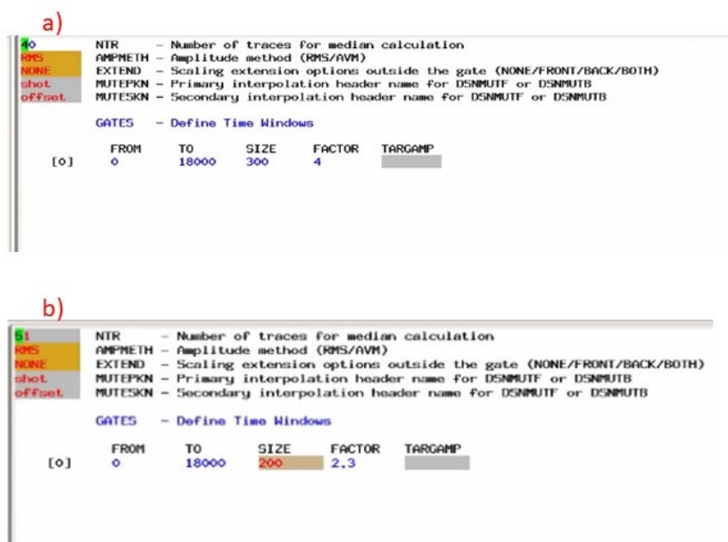
Figura 35 – Parâmetros do AMPSCAL aplicados em: a) águas rasas e b) águas profundas. Com variação no NTR- número de traços para cálculo médio e Gate- Tamanho da janela de análise.
