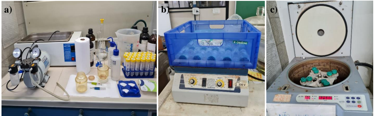
Figura 19 - Procedimentos comuns ao final de cada fase da extração sequencial de metais pesados: a) Bomba de Vácuo utilizada para filtragem e separação do resíduo e sobrenadante de cada fase. b) Agitador utilizado para a lavagem das amostras de sedimento c) Centrífuga utilizada para aceleração da sedimentação das partículas e separação dos extratos.
