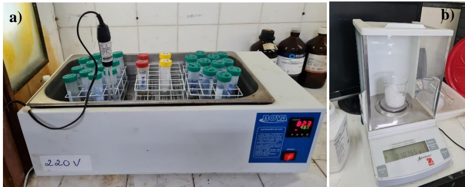
Figura 22 - Procedimentos de extração da fração oxidável das amostras em estudo (F3): a) amostras em aquecimento em banho maria; b) pesagem de alíquota de acetato de amônio a ser utilizado nesta etapa.
