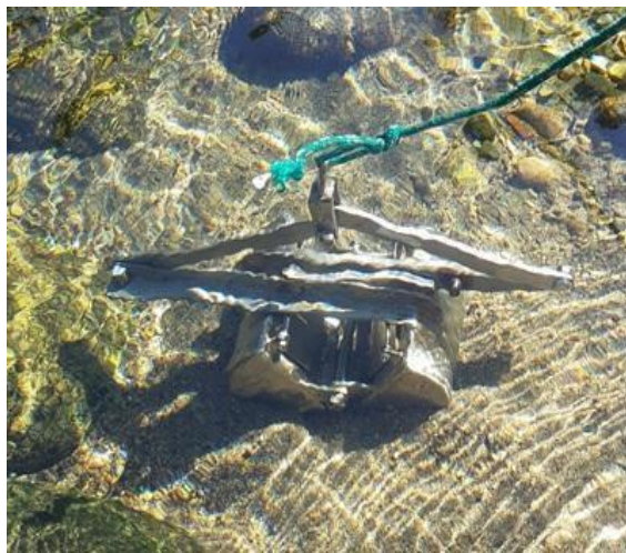
Figura 16 - Amostragem de sedimentos de fundo a partir da draga Van Veen.
