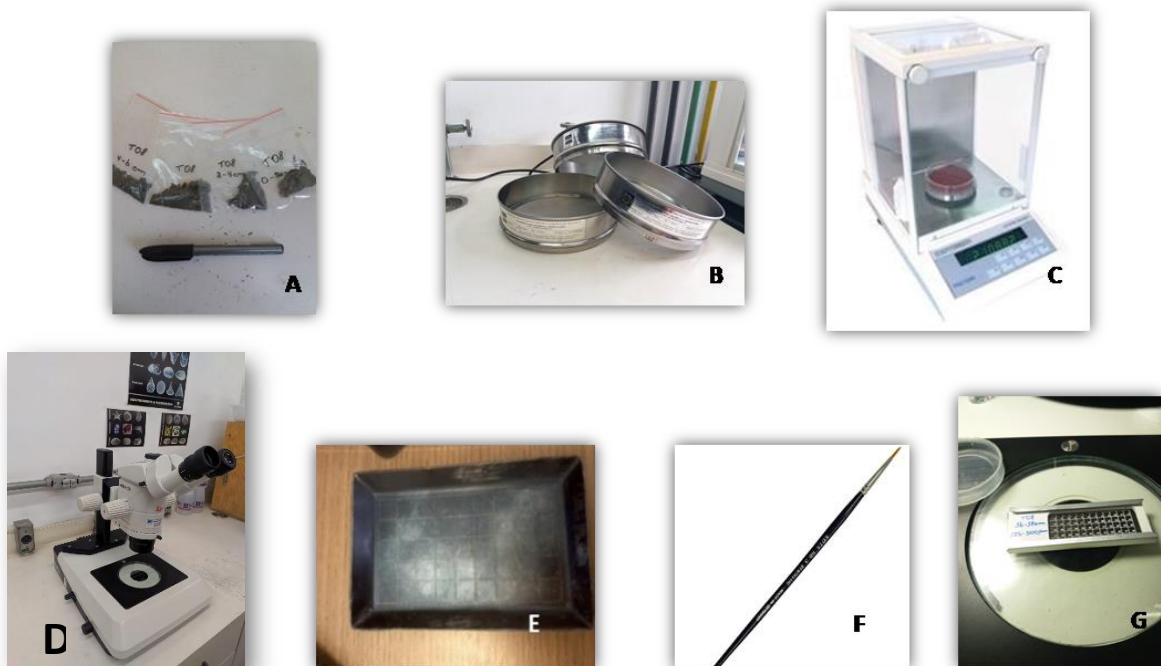
Figura 8: Etapas de tratamento das amostras. A – Amostras acondicionadas e etiquetadas por horizonte; B – Peneiras de lavagem a úmido, malhas 0,500 mm (500 \mu\text{m} ) e 0,063 mm (63 \mu\text{m} ); C – Balança analítica; D – Microscópio estereoscópio utilizado para triagem do material; E- Plaqueta quadriculada de triagem; F- Pincel de pelo de marta n.º 000, para separação e coleta dos espécimes; G – Lâmina quadriculada para armazenamento dos exemplares encontrados.
