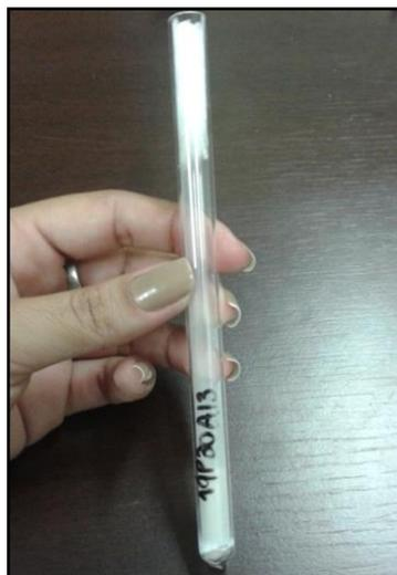
Figura35: Tubo de combustão com reagentes, amostra e lã de vidro.
