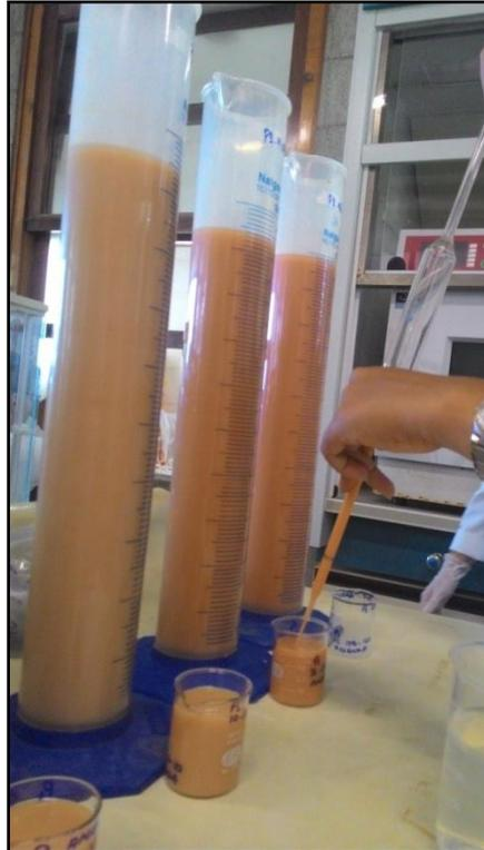
Figura 26: Argila decantada nas provetas de 1000 ml, sendo pipetadas para os beckers de 50 ml.
