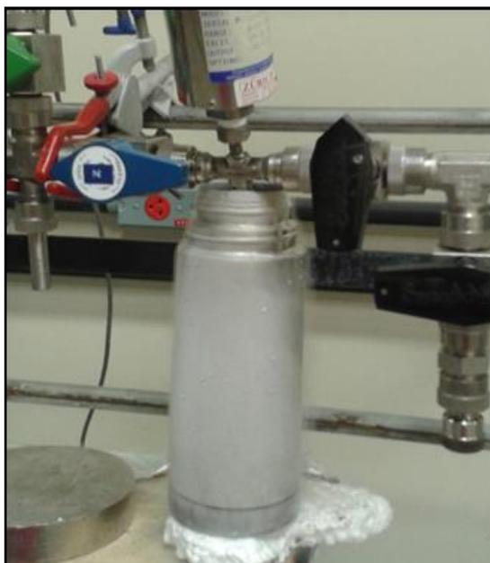
Figura 39 – Armadilha com nitrogênio líquido.
