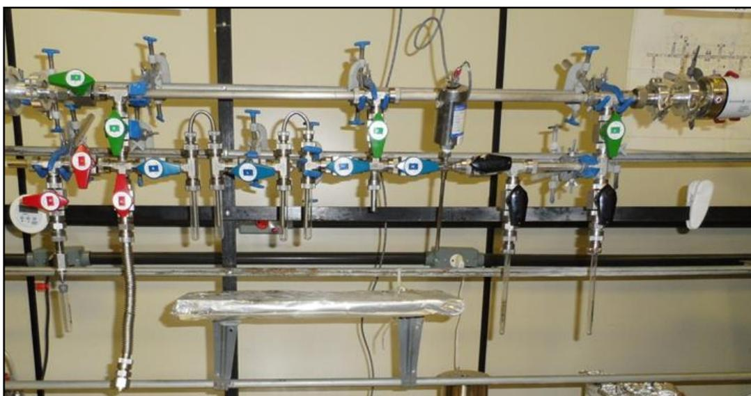
Figura36: Linha de vácuo do Laboratório de Radiocarbono da UFF.
