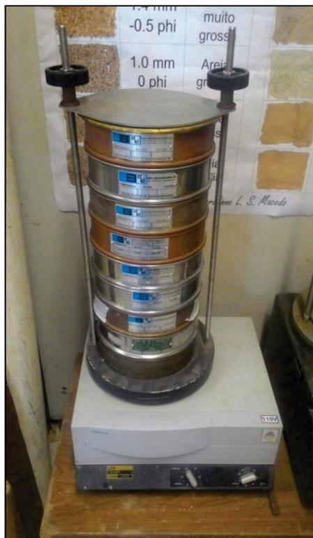
Figura 24: Conjunto de peneiras sobrepostas no agitador para a separação das frações.
