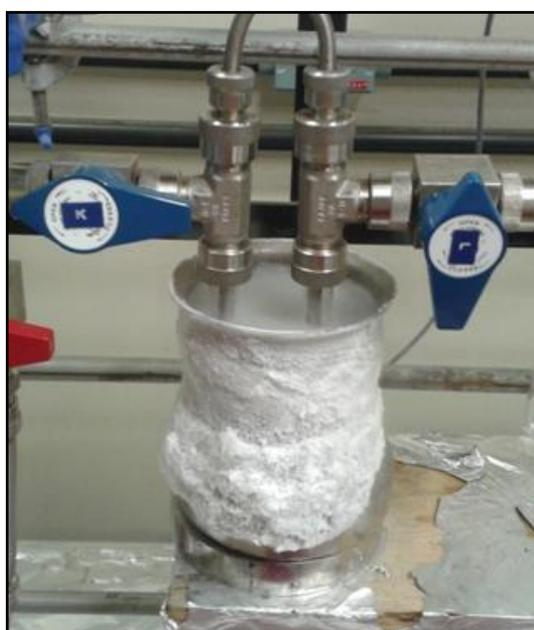
Figura 38– Armadilha de gelo seco triturado, nitrogênio líquido e álcool etílico.
