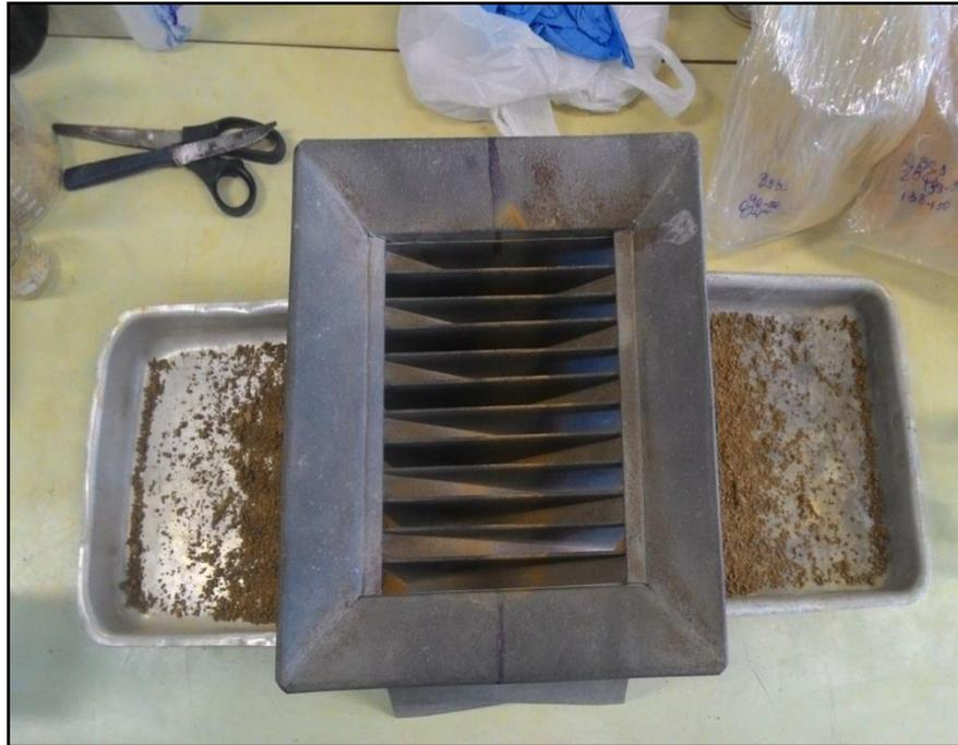
Figura 23: Quarteador usado na análise granulométrica.
