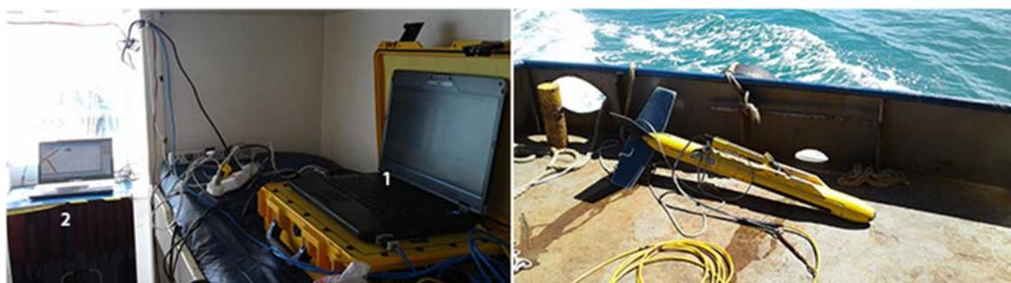
Figura 24. À esquerda são exibidos o (1) Processador Topside do sistema do Sonar de Varredura Lateral e (2) A navegação no sistema Hypack. À direita é mostrado o Sonar de Varredura Lateral Edge-Tech 272-TD utilizado nos levantamentos sonográficos.
