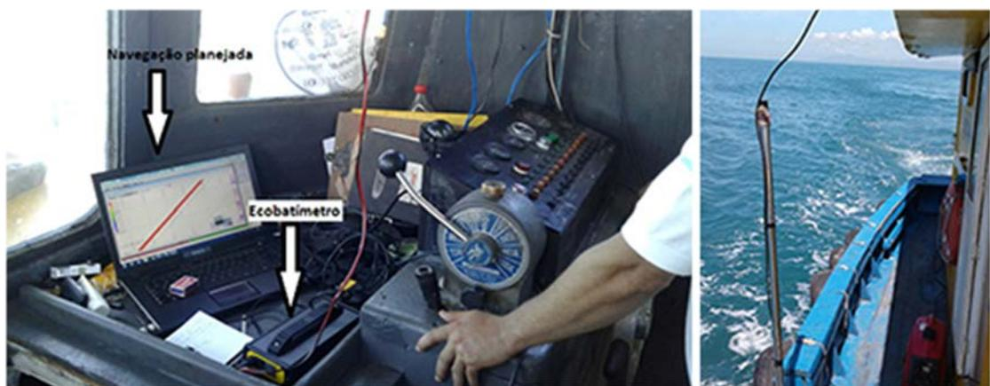
Figura 23. À esquerda é observado o sistema de aquisição da batimetria. À direita é apresentada a haste de suporte ao o sensor acústico de aquisição batimétrica.
