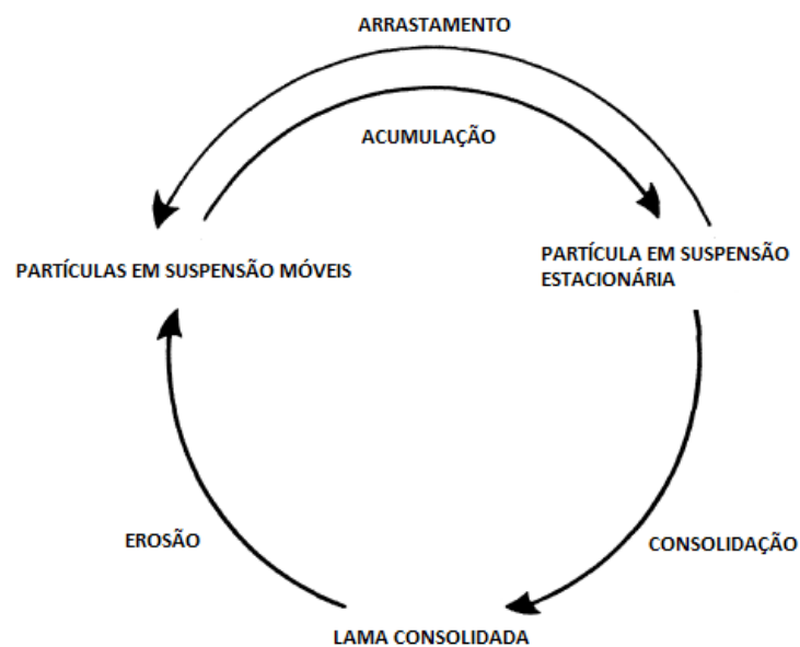
Figura 5- Modelo que mostra o estado de ocorrências e conexão dos processos comportamentais dos sedimentos coesivos. Fonte: Modificado de Kirby e Parker, 1983.
