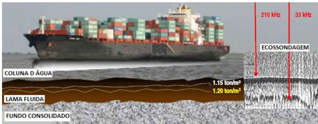
Figura 6-Visão geral de manobra de um navio navegando em área lamosa. Fonte: Modificado de DELEFORTRIE, 2006
