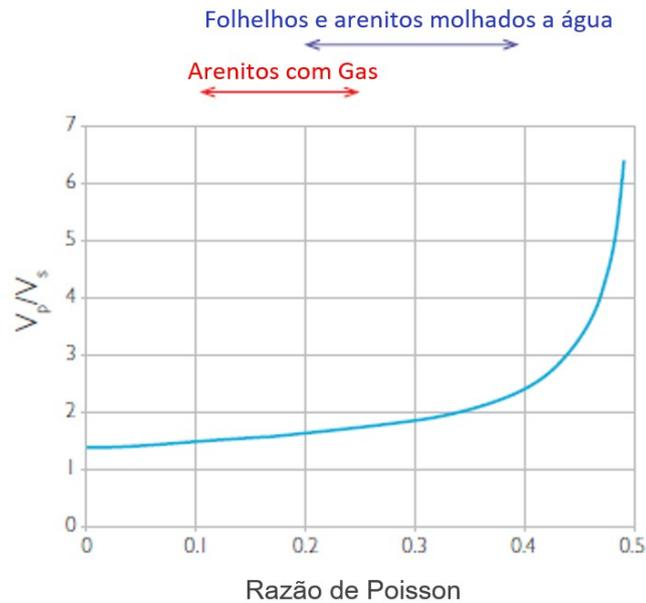
Figura 74: Relação entre  $V_p/V_s$  e razão de Poisson (modificado de Simm & Bacon, 2014).
