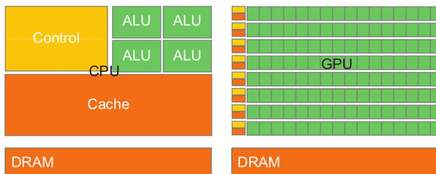
Figura 14 – Ilustração da arquitetura da CPU, à esquerda e da GPU, à direita. Retirado de [Kirk e Hwu \(2010\)](#).
