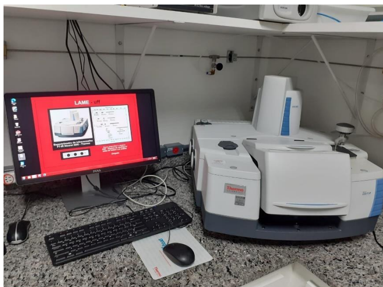
Figura 23. Espectrômetro Nicolet iS50 FTIR utilizado na pesquisa
