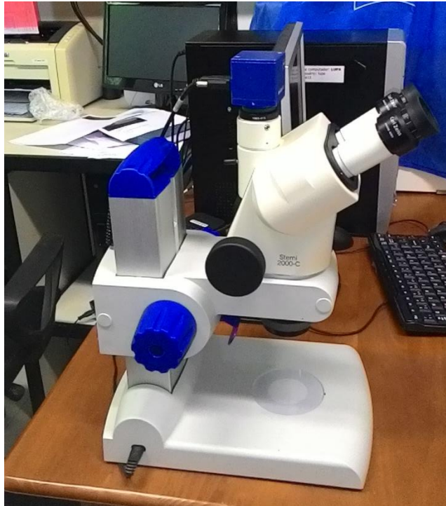
Figura 20. Estereomicroscópio do modelo Zeiss STEMI 2000 C utilizado durante todo o processo de pesquisa.
