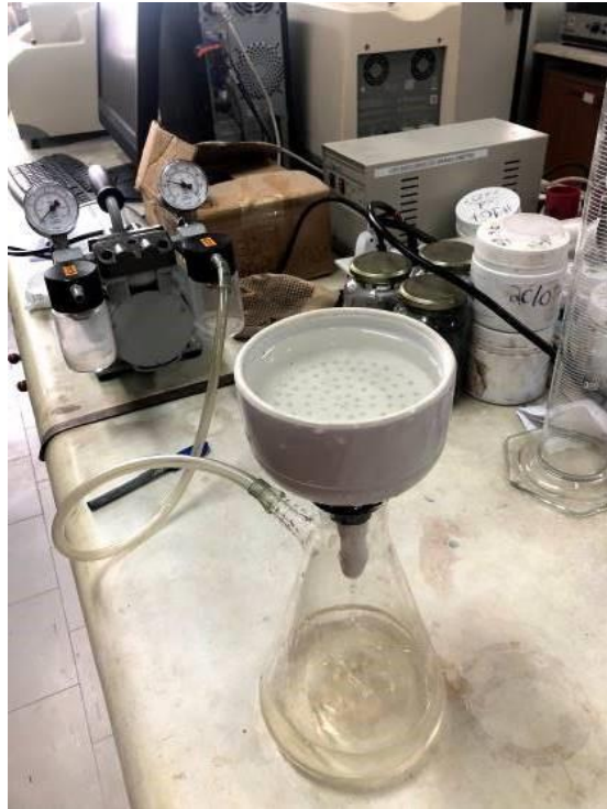
Figura 19. Filtragem utilizando a bomba a vácuo.
