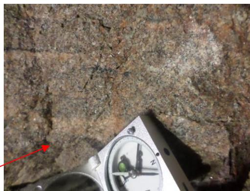
Figura 4.1.5- Detalhe rocha sã, granito rosado de textura equigranular média a grossa, constituído por quartzo, feldspato K, e biotita predominantemente, tirada em 26/05/2018.
