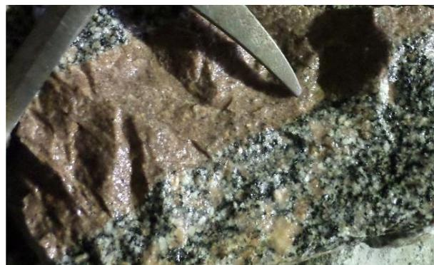
Figura 4.1.11- Região do emboque- classe II, no Km 121,672. Fraturas preenchidas por leucogranitoides róseos equigranulares, finos pegmatitos, tirada em 25/06/2018.
