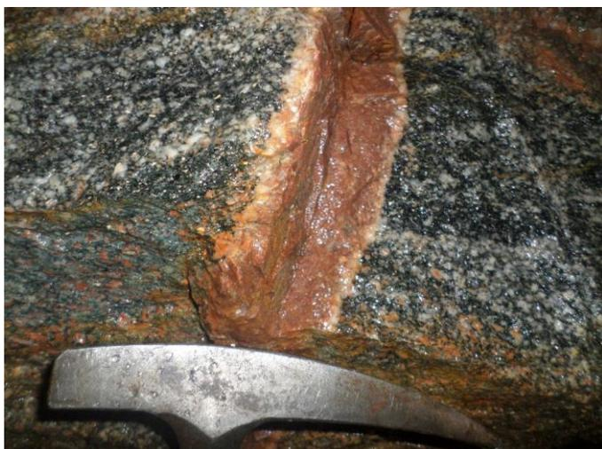
Figura 4.1.10- Região do emboque- classe II, no Km 121,672. Fraturas preenchidas por leucogranitoides róseos equigranulares, com granulometria fina e borda pegmatóide, tirada em 25/06/2018.
