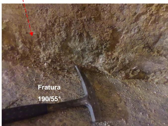
Figura 4.1.13- Região do emboque- Classe III, no Km 121,694. Plano de fratura alterado (esverdeado), orientação do mergulho (190/55°). Rocha são granito rosado, tirada em 04/07/2018.
