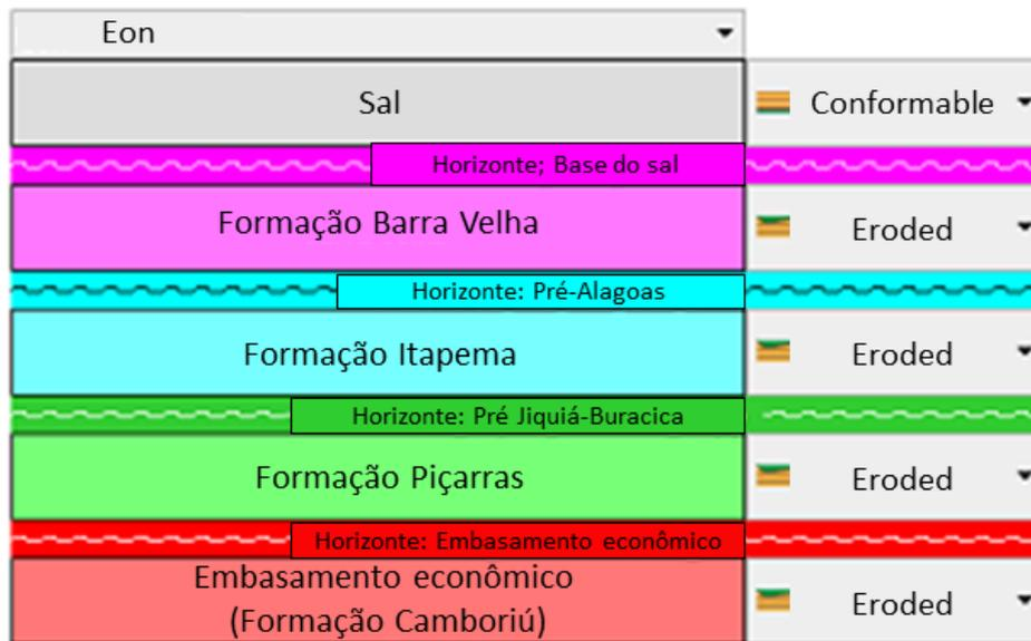
**Figura 29:** Coluna estratigráfica utilizada para a construção do modelo estrutural tridimensional. A característica “eroded” como *input* foi utilizada para representar descontinuidades.
