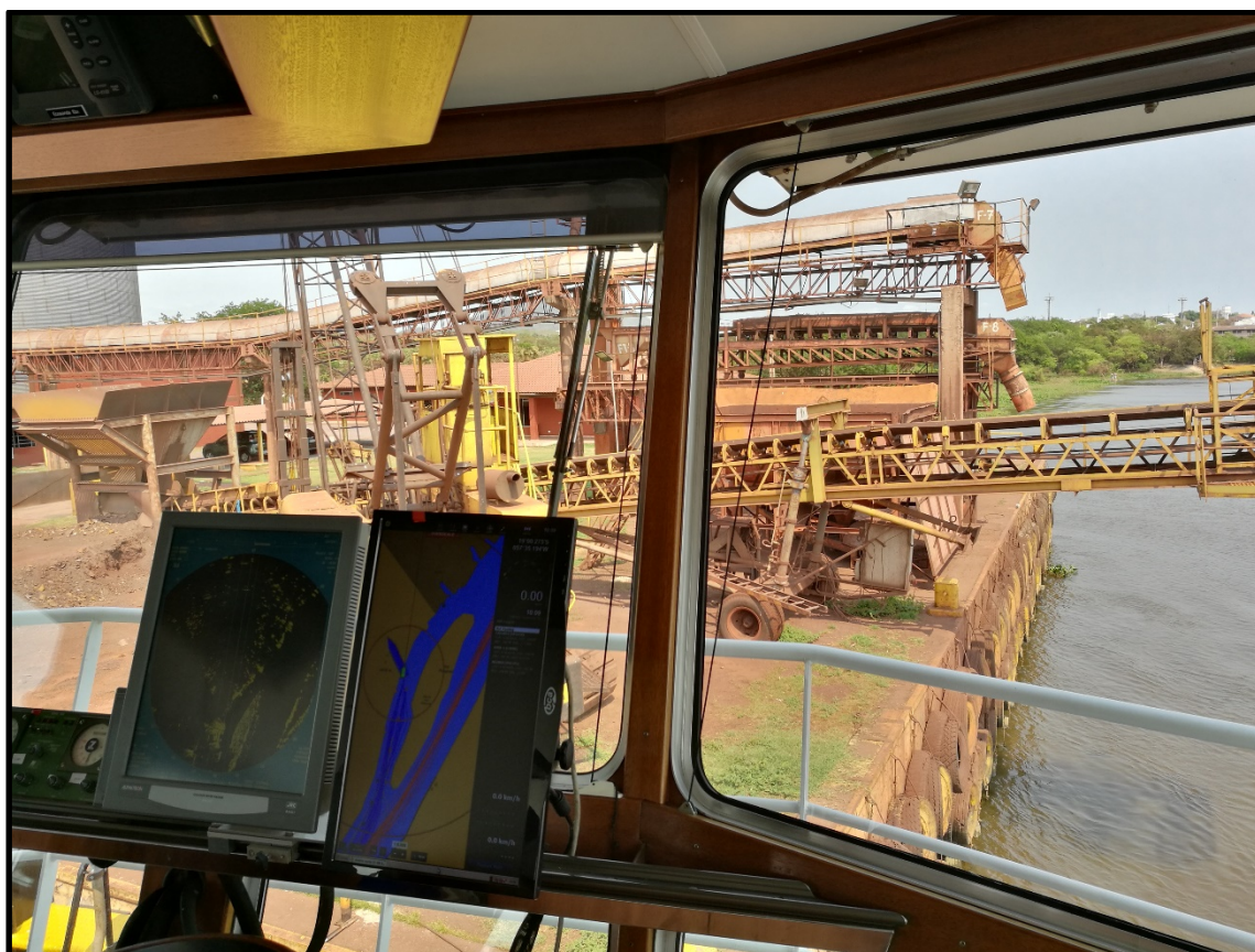
Figura 24: Sistema de navegação do empurrador Herkules XVI (Fonte: autora).
