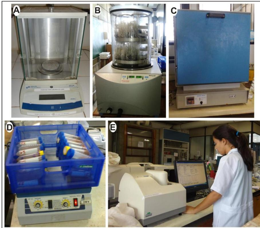
Figura 21 – Principais etapas de análise dos sedimentos predominantemente lamosos. (A) Balança, (B) liofilizador, (C) mufla, (D) agitador e (E) granulômetro para lama.
