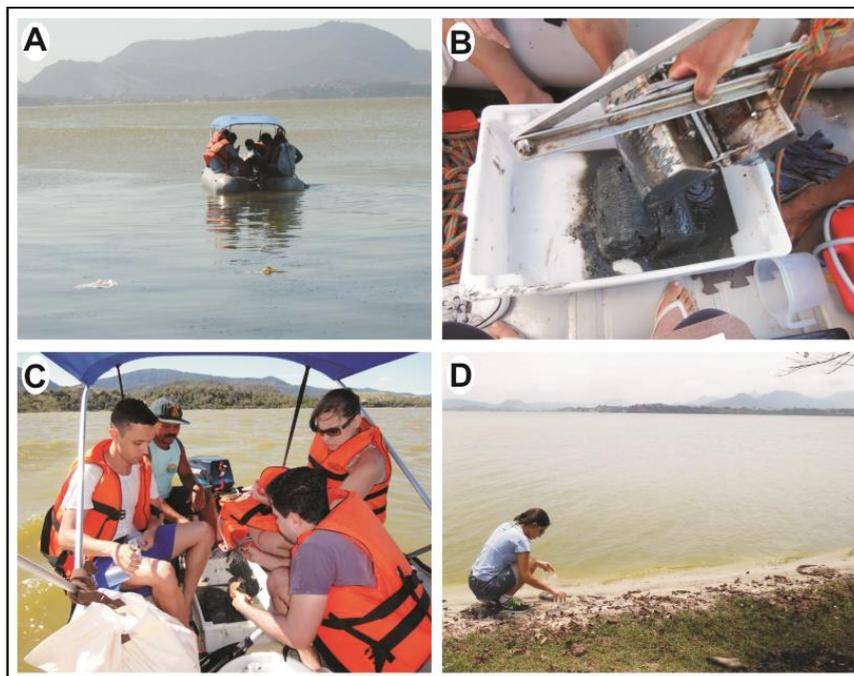
Figura 14 – (A) Trabalho de campo na Lagoa de Maricá, (B e C) coleta de sedimentos de fundo com o amostrador *van Veen* e (D) da margem lagunar.
