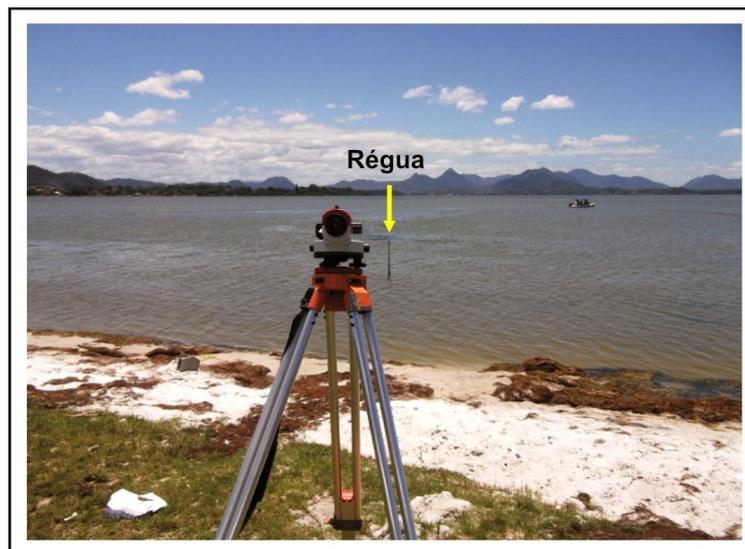
Figura 17 – Medição da variação de maré utilizando uma régua de medida vertical (seta amarela) e o teodolito.
