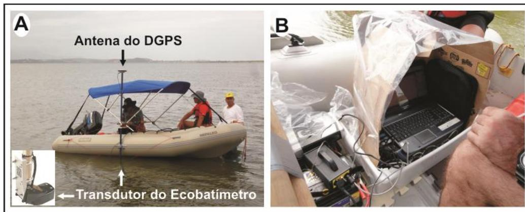
Figura 16 – (A) Ecobatímetro (setas branca) e DGPS (seta preta) acoplados ao bote e (B) o acompanhamento da aquisição de dados.
