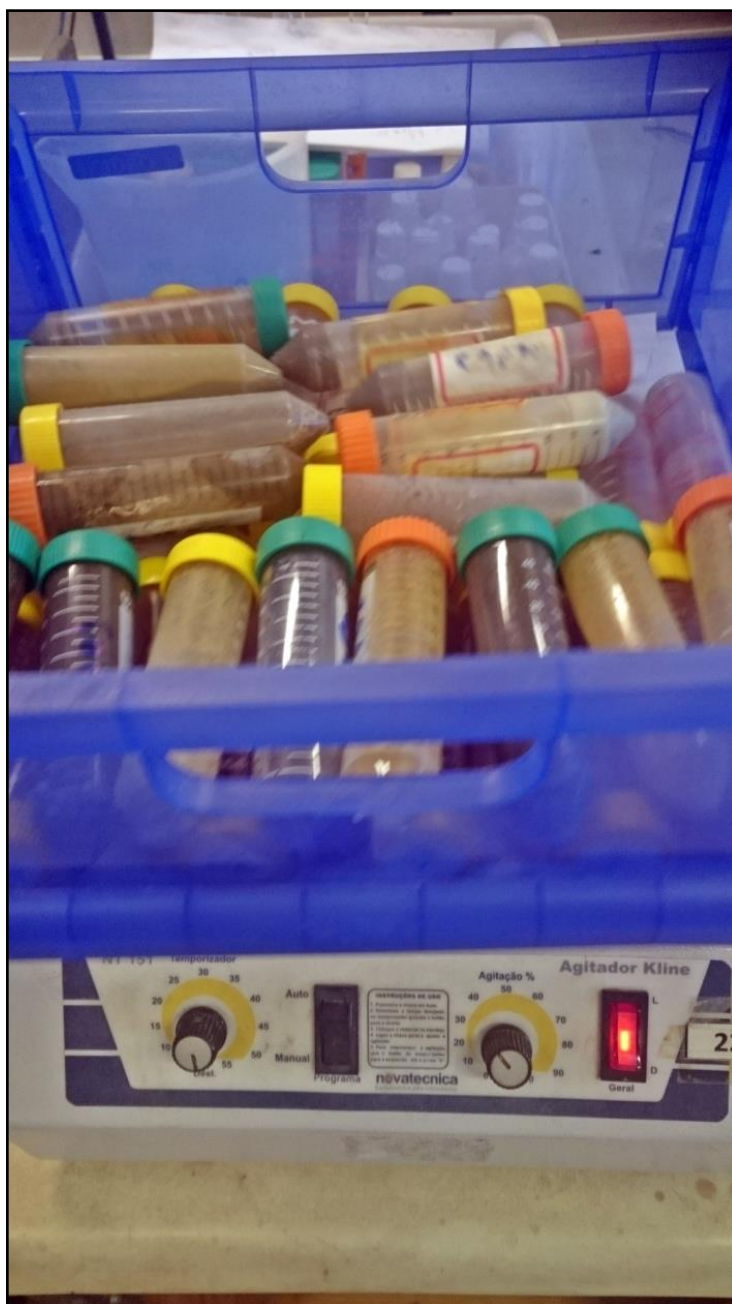
Figura 32: Amostras no agitador mecânico durante a fase de extração de carbonatos (Foto: Gomes, 2017)
