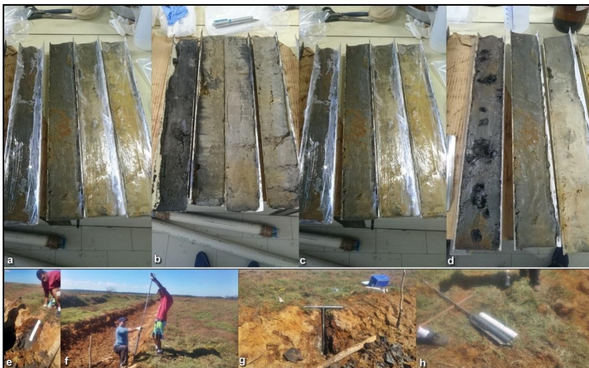
Figura 31: a, b, c, d) Fotos feitas em laboratório durante a descrição dos testemunhos; e, f, g, h) fotos feitas durante coleta (Fotos: Gomes e Silva, 2016)
