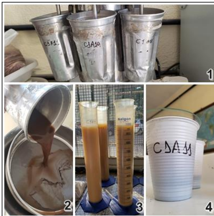
Figura 36: Etapas da análise granulométrica. 1 – amostras no agitador elétrico “stirrer”; 2 – lavagem do sedimento retido na peneira; 3 – agitação do material na proveta; 4 – solução de água destilada + NaOH + sedimento. Fotos: Gomes 2019.
