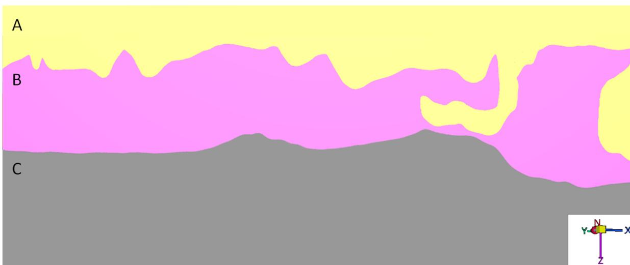
Figura 16: Imagem ilustrativa das regiões utilizadas para a confecção do modelo de velocidade, da seção *inline* 5000. A exibe a porção pós-sal (Amarelo), B a camada de sal (Roxo) e C a seção pré-sal (Cinza). No pacote de sal fica evidente as feições de muralha de sal e multi-z.
